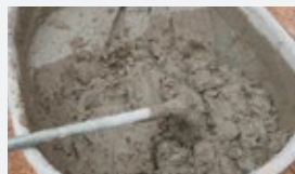
► Mortero con pérdida de agua
